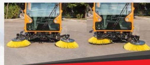
Ancho de barrido ajustable durante la operación
